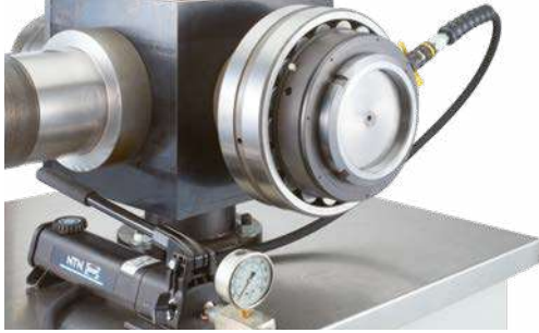
Adaptör manşonunun hidrolik somun ile sökülmesi
