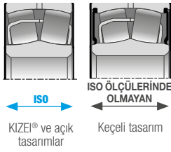
Şekil 19: KIZEI® rulman, açık oynak makaralı rulman ile aynı ISO genişliklerinde mevcuttur
